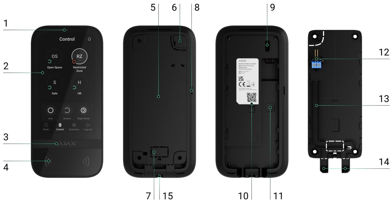
1. Umgebungslichtsensor zur automatischen Anpassung der Helligkeit der Displaybeleuchtung.
